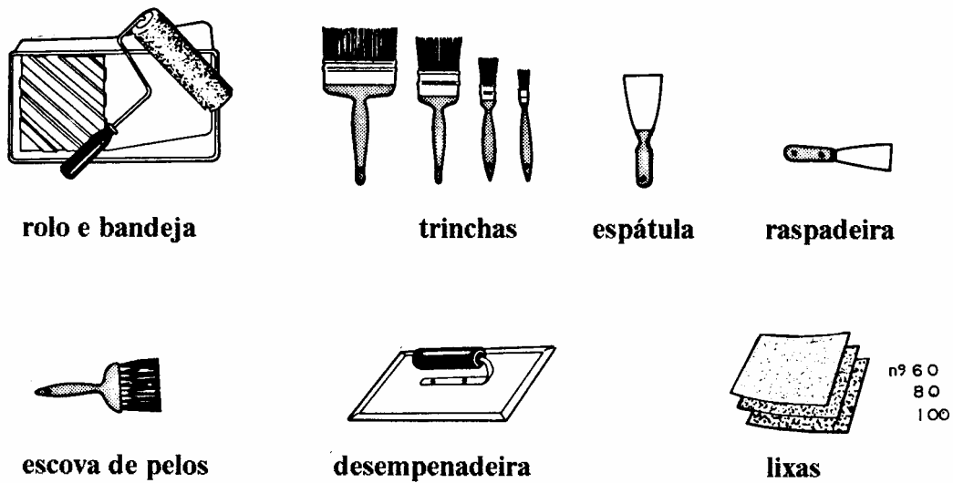
Figura 10.3 - Materiais utilizados no preparo e aplicação das pinturas em paredes
