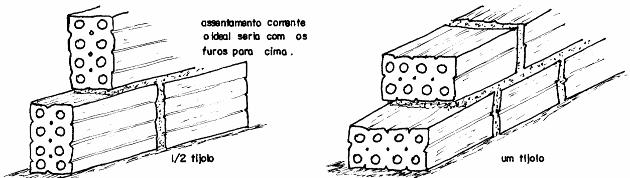
Figura 4.27 - Execução de alvenaria utilizando tijolos furados
