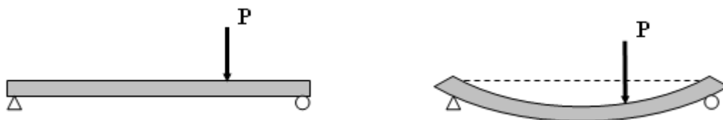
Figura 51 – Deformação de uma viga submetida à flexão
